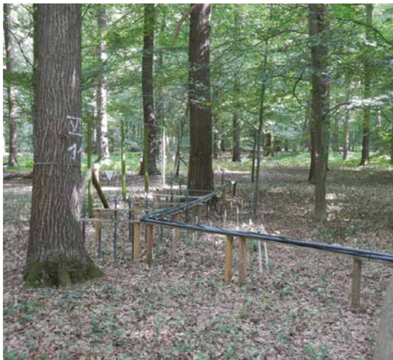
Messung der Bodenwasserspannung mit Tensiometern auf der Level-II-Fläche Kleve Tannenbusch
